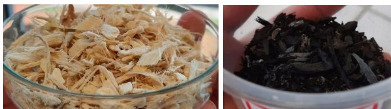
Figura 1: Granulometria Grande da Casca da Moringa e seu respectivo carvão ativado produzido.
