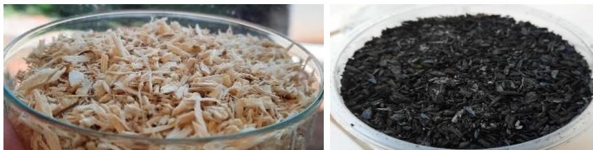
Figura 2: Granulometria Pequena da Casca da Moringa e seu respectivo carvão ativado produzido.
